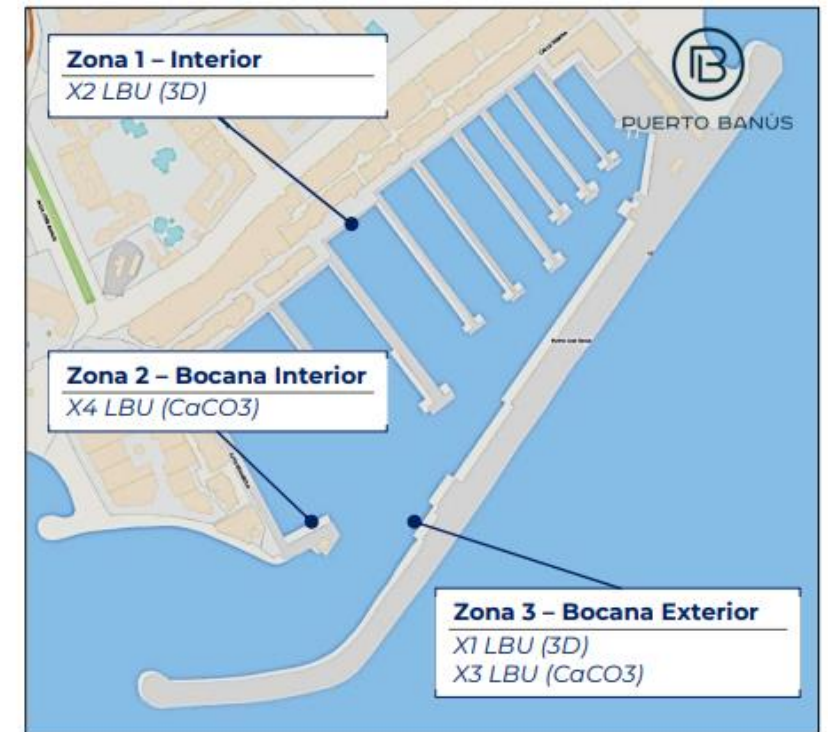
Imagen 1 – Localización y número de estructuras LBU instaladas en Puerto Banús. Se indica también los tipos de LBU ubicados en cada punto (3D: prototipo de impresión 3D; CaCO3: prototipo carbonatado).
